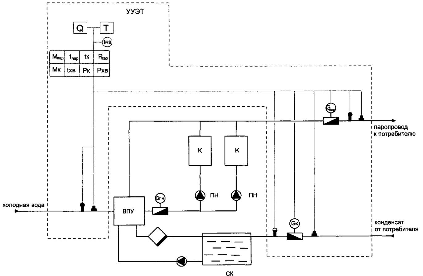
Рисунок 8. Принципиальная схема размещения точек измерения количества тепловой энергии и массы (объема) теплоносителя, а также его регистрируемых параметров на источнике тепловой энергии для паровых систем теплоснабжения. К - котел, ВПУ - водоподготовительная установка, ПН - питательный насос, СК - сборник конденсата.
