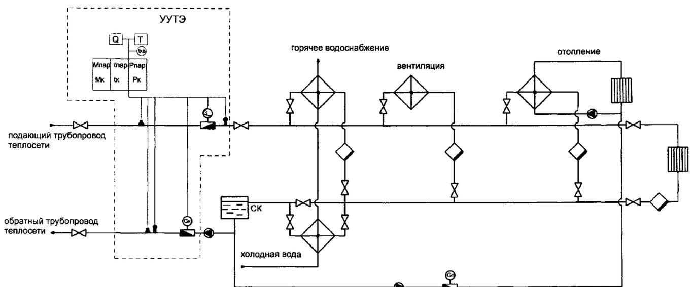
Рисунок 9. Принципиальная схема размещения точек измерения количества тепловой энергии и массы (объема) теплоносителя, а также его регистрируемых параметров для каждого самостоятельно подключенного вида тепловой нагрузки в паровых системах теплоснабжения. СК - сборник конденсата.
