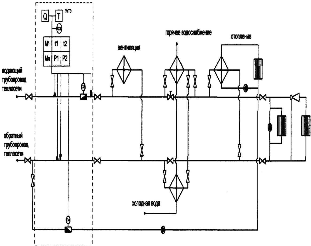
Рис. 4. Принципиальная схема размещения точек измерения количества тепловой энергии и массы (объема) теплоносителя, а также его регистрируемых параметров в закрытых системах теплоснабжения на тепловых пунктах (ЦТП, ИТП).
